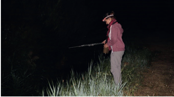
Figure 7. Localisation des femelles à l'aide de l'antenne Yagi et du boîtier récepteur ATS ©PNPC.
